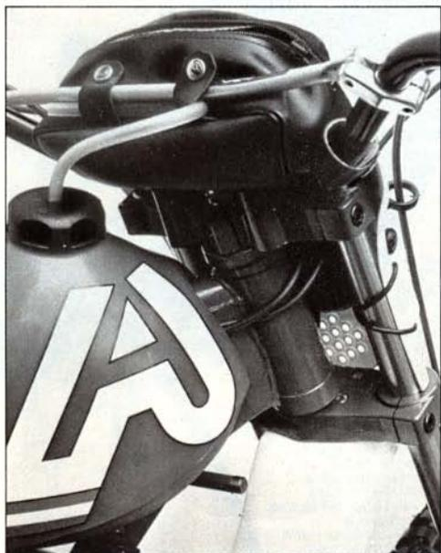
*Il canotto di sterzo ruota su rulli conici mentre le robuste piastre della forcella sono configurate in modo tale da ridurre a valori minimi l'avanzamento degli steli: sono due soluzioni tipicamente corsaiole. La dotazione di ferri e il manualetto (che riguarda solo il motore) sono racchiusi in una borsetta fissata al manubrio, che non impaccia la guida ma che è soggetta a sporcarsi per la sistemazione poco felice dello sfiato del serbatoio.*
