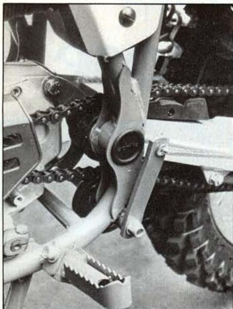
Robusti e ben fatti gli attacchi del motore e i fazzoletti di rinforzo in prossimità del perno del forcellone. La seghettatura delle pedane consente un'ottima presa anche con le calzature sporche di fango.
